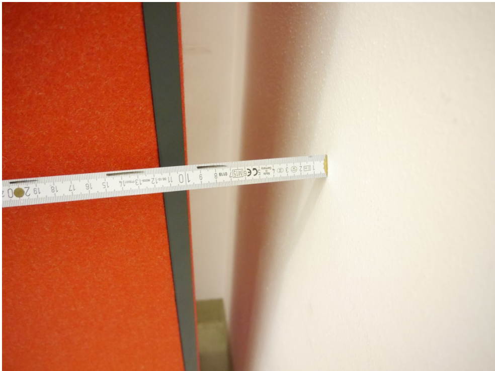
Abbildung B.3. Akustiksäule ARTbase: Aufbau 2 in Raumecke, 100 mm Abstand zwischen Längskante der Akustiksäule und angrenzender Hallraumwand.
