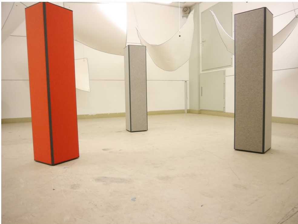
Abbildung B.2. Akustiksäule ARTbase: Prüfaufbau im Hallraum (Aufbau 1 in Raummitte).
