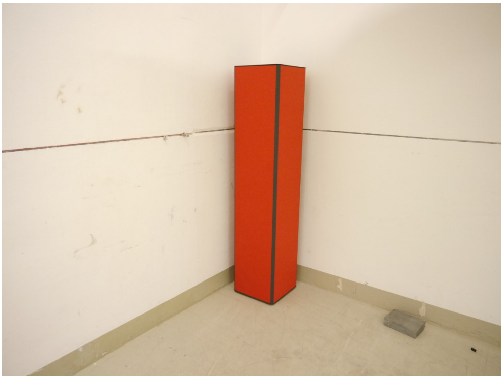
Abbildung B.4. Akustiksäule ARTbase: Prüfaufbau im Hallraum (Aufbau 2 in Raumecke).
