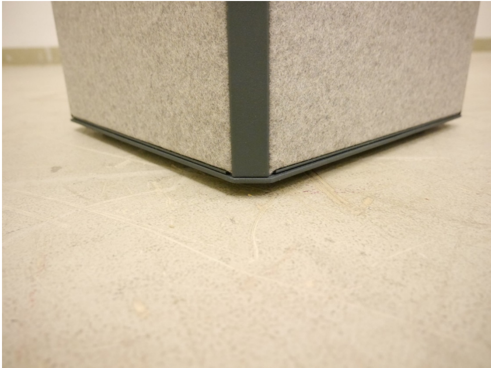
Abbildung B.1. Akustiksäule ARTbase: Aufbau 1 in Raummitte, Detail Fußpunkt auf dem Hallraumboden.
